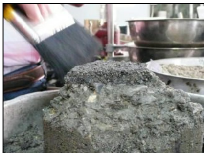
Figura 1. Penetración de emulsión asfáltica en riego de imprimación
