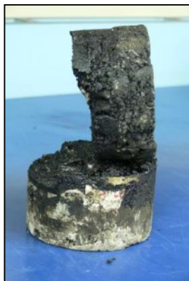
Figura 3. Rompimiento en la base en muestra con emulsión asfáltica
