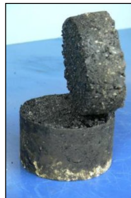
Figura 4. Desplazamiento entre fases en muestra con RC-250
