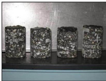
Figura 11. Coredrillos tomados del tramo experimental 6 meses después de aplicado el riego
